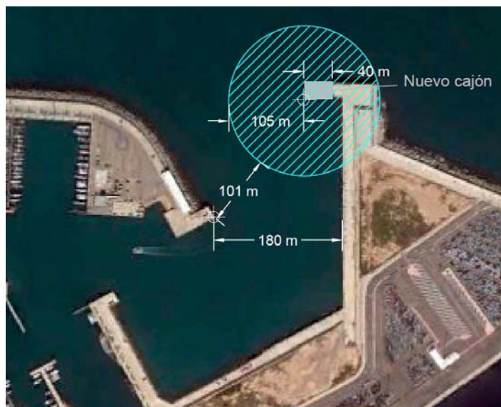
Figura 5.- Anchura mínima de la bocana según la ROM. Configuración futura.
